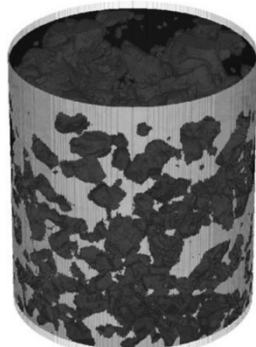
図3：模擬電極のX線CT3次元像 ※模擬活物質(黒)と固体電解質(灰色)の3次元的な構造の計測に成功した
